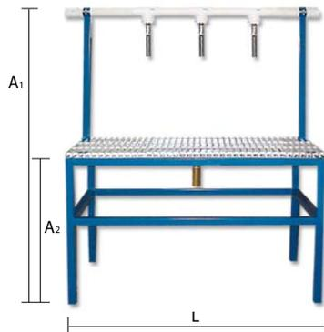
Llenadora para garrafones de agua de 19 litros, marca Instapura. Con cabezal de PVC de 2" tipo manual con válvulas de esfera de operación rápida de 3/4" para llenar simultáneamente garrafones. Mesa con cubierta de rejilla de fibra de vidrio y charola colectora de acero inoxidable. Armazón de PTR de 1-1/2" con recubrimiento de pintura electrostática en polvo horneada protectora contra la corrosión. También disponible con armazón de acero inoxidable.
